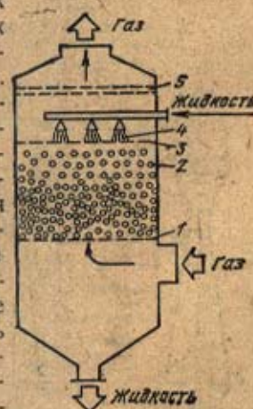
Рис. 5.12. Скруббер с псевдооживленной насадкой
